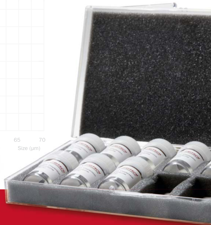
Patrones para calibrar el equipo de medición
