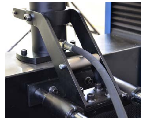
Salida del aceite del Dispositivo para ser acoplado a la entrada de aceite de la Estructura de 2.000kN.
