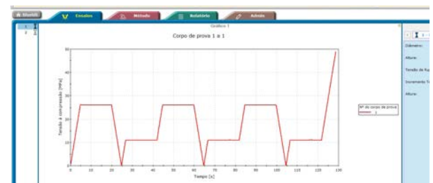
Ensayo de Módulo en Concreto de Forma Automática.
