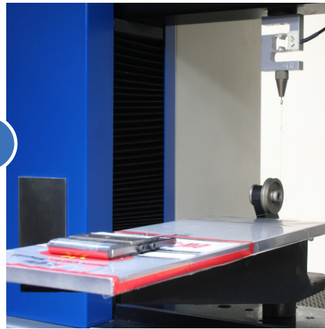
El dispositivo COF de EMIC cumple perfectamente ASTM D1894. Juntamente con el software Bluehill es posible determinar los coeficientes de rozamiento estático y dinámico.
