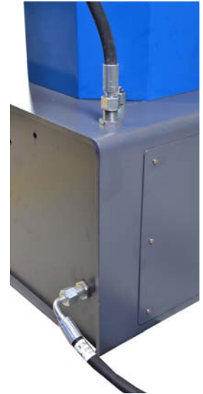
Detalle de la Entrada de Aceite en la Estructura de 2.000kN
