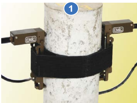
Instrumentación Electrónica de la Serie 23 posibilita el uso de 2 canales simultáneos de deformación
