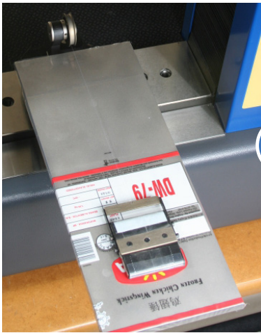
El dispositivo COF de EMIC cumple perfectamente ASTM D1894. Juntamente con el software Bluehill es posible determinar los coeficientes de rozamiento estático y dinámico.
