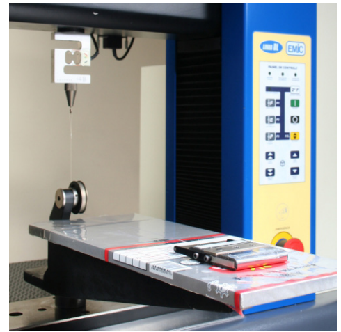
El dispositivo COF de EMIC cumple perfectamente ASTM D1894. Juntamente con el software Bluehill es posible determinar los coeficientes de rozamiento estático y dinámico.
