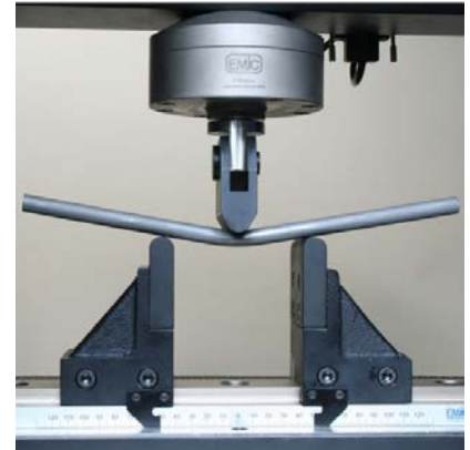
Los dispositivos EMIC para flexión se utilizan para ensayos en polímeros, metales, cerámicos etc
