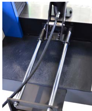
Sistema de retiro del Dispositivo hacia la parte trasera de la Máquina cuando no está en uso.
