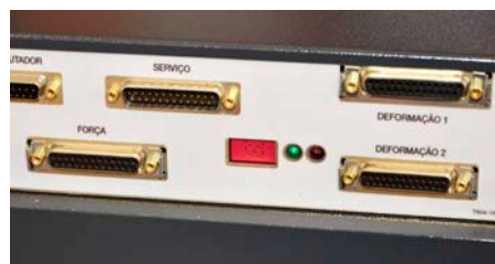
Instrumentación Electrónica de la Serie 23 posibilita el uso de 2 canales simultáneos de deformación
