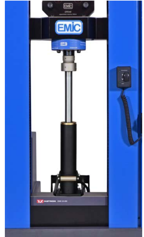
Detalle del montaje del Dispositivo en una Máquina Universal de la Serie 23
